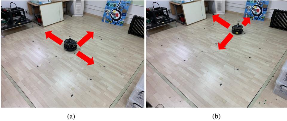
그림 5.6: 방법1 을 설명해 놓은 그림. (a) 는 집에서의 방향을 결정하는 이미지이고 (b) 는 이후 스텝에서 로봇이 랜덤하게 방향을 설정하는 이미지이다. 위 방법처럼 탐사를 시행하고 매 스텝이 끝나게 될때마다 탐사 이미지를 수집하게 된다.
