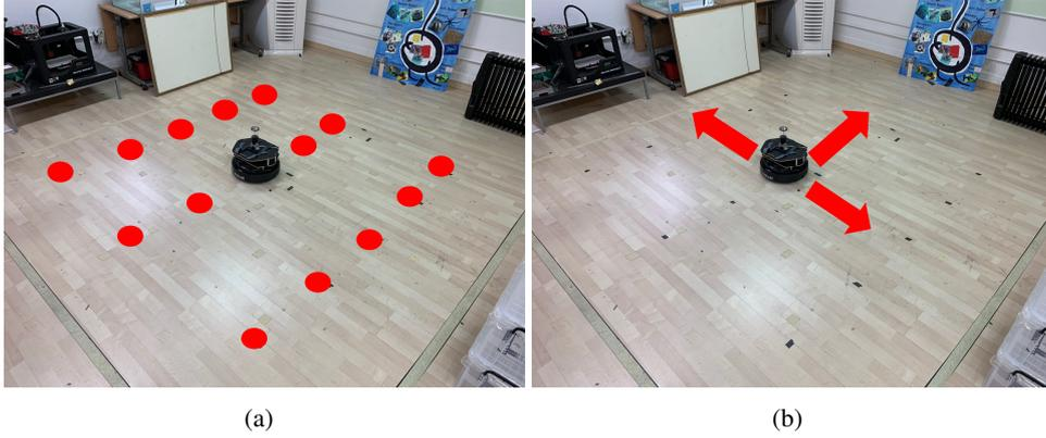
그림 5.7: Landscape 기반 학습. (a)의 빨간 점은 미리 탐사가 이루어진 위치. (b) Landmark 빨간 점이 있는 위치에서 선행 탐사로 수집된 이미지 데이터를 학습의 테스트 데이터로 이용하여 학습을 미리 진행하게 된다. 이후 (b)와 같이 로봇이 랜덤한 방향으로 탐색을 한다. 이후에 방향 결정이 필요한 시점에서 이전에 학습된 가중치를 이용하여 방향 결정을 하게 된다.
